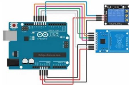
Gambar 4. Wiring Diagram Rangkaian Pengaman Motor
