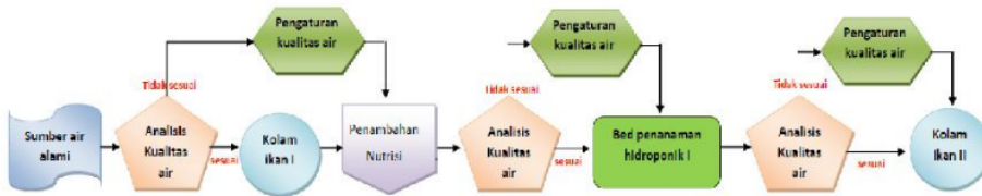
Gambar 1. Model Natural Hydroponic Technology (NHT) dengan satu Green House dan dua kolam ikan
