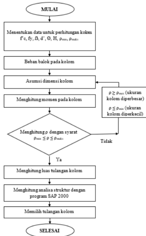
Gambar 5 Bagan Alir Perhitungan Kolom. Pada gambar 2 dijelaskan tahapan perhitungan kolom Perencanaan Struktur Museum Permainan Anak Tradisional Di Bringin Kecamatan Ngaliyan.
