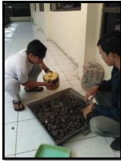
Pengayakan slag di lab. Teknik sipil UPGRIS
