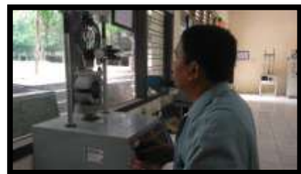
Pengujian briket aspal beton dengan alat Marshall di lab. Teknik sipil UPGRIS
