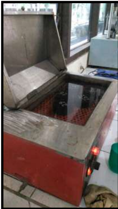
Proses pembuatan briket campuran aspal panas beton di lab. Teknik sipil UPGRIS
