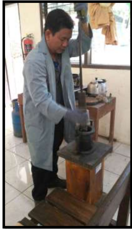
Proses pembuatan briket campuran aspal panas beton di lab. Teknik sipil UPGRIS
