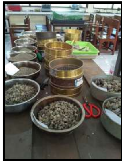
Hasil pengayakan agregat di lab. Teknik sipil UPGRIS
