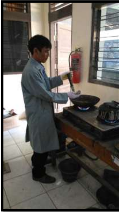
Proses pembuatan briket campuran aspal panas beton di lab. Teknik sipil UPGRIS
