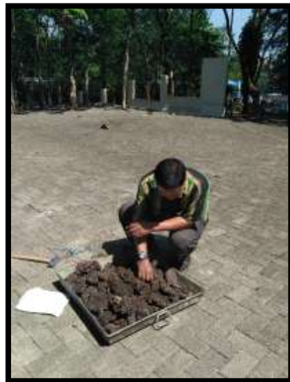
Pengeringan slag di lab. Teknik sipil UPGRIS
